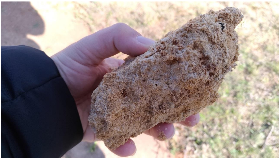
Figura 7 - Amostra de solo retirada do fundo da trincheira, profundidade aproximada de 3 metros
