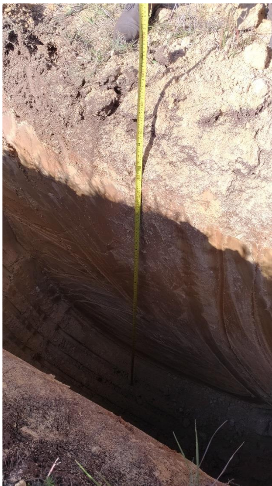
Figura 3 – Trincheira, profundidade de 3 metros
